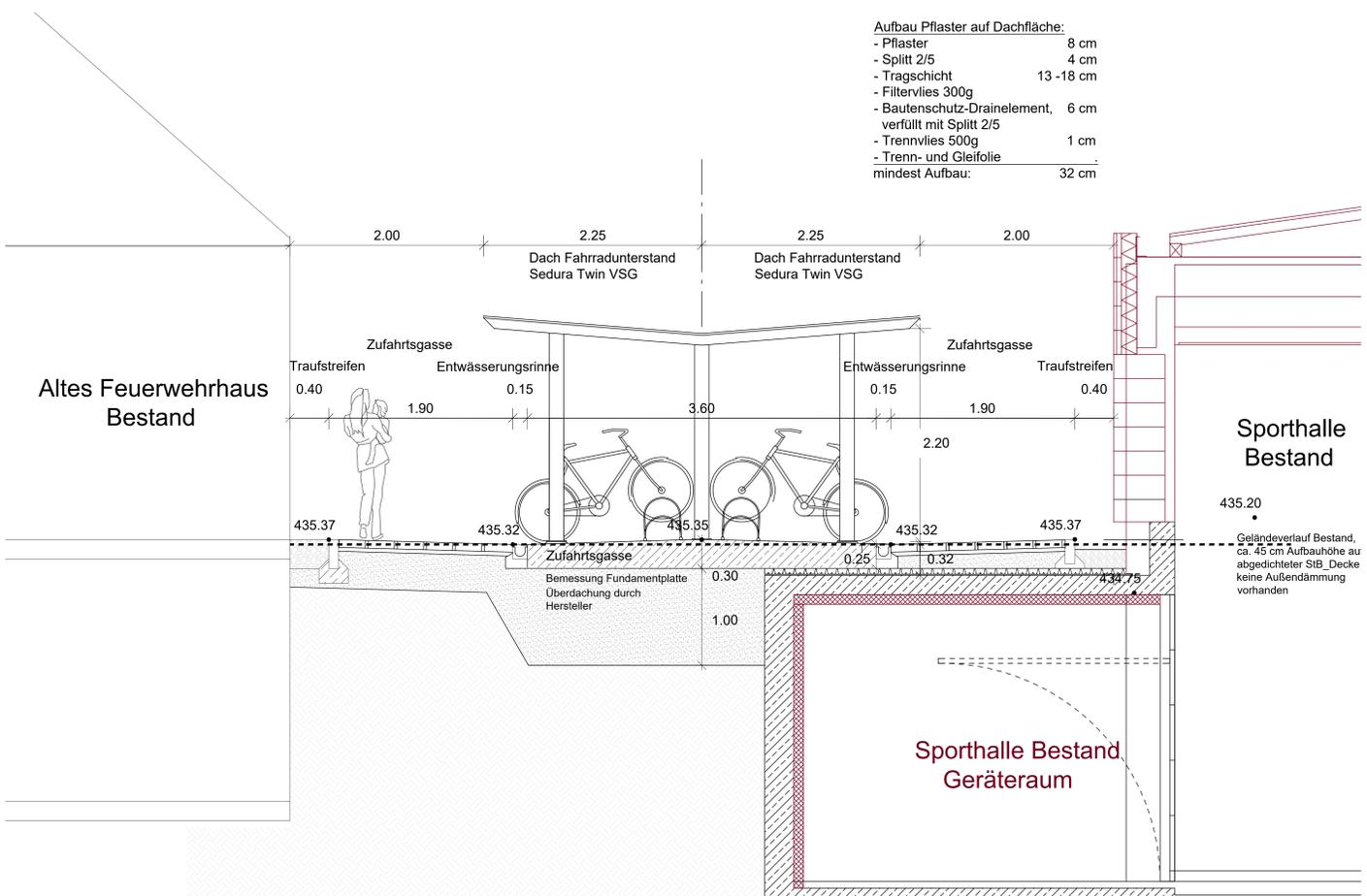
Grundriss Ortbetonbelag mit Fahrradüberdachung, M. 1:25
